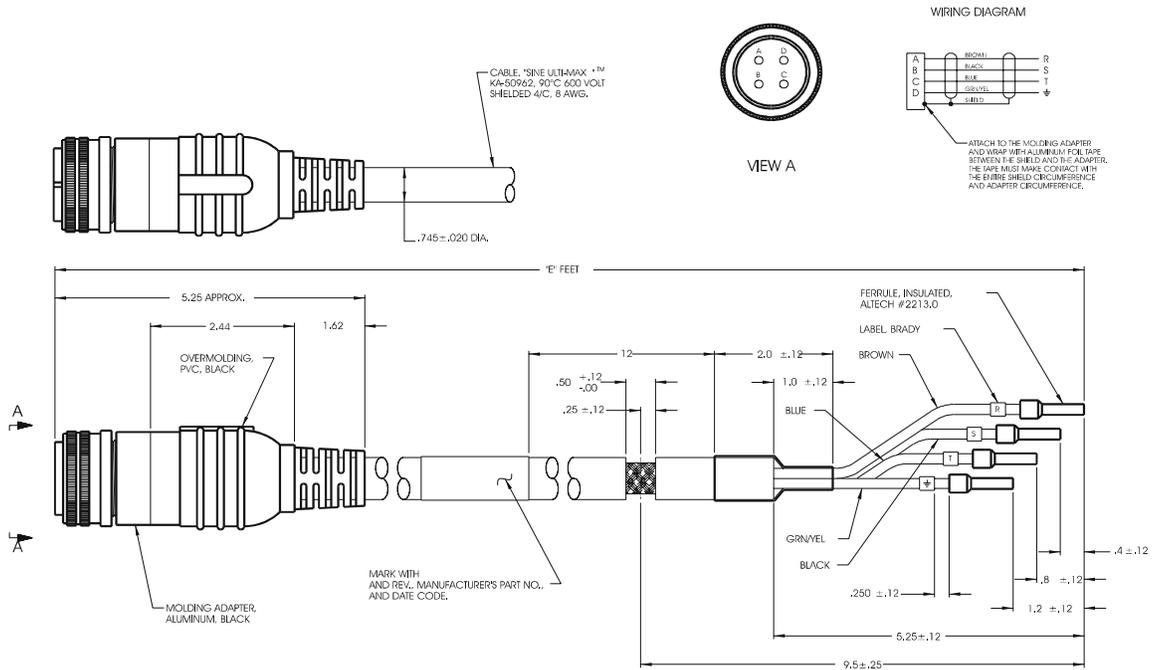
Figure B.23 8000 H-Series Power Cable (P/N 9101-1384)
