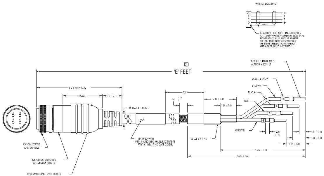
Figure B.22 6300 H-Series Power Cable (P/N 9101-1399)
