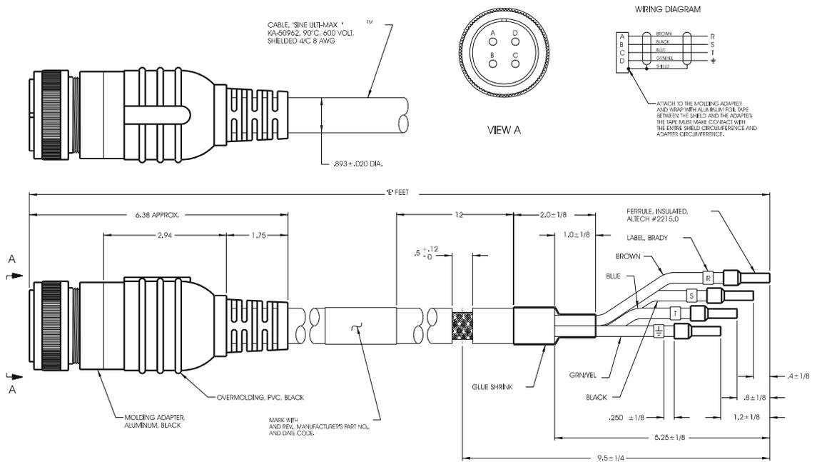
Figure B.24 Y-Series Power Cable (P/N 9101-1385)
