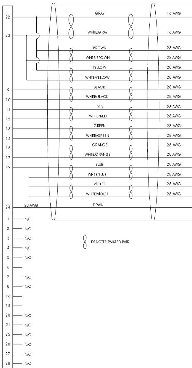
Figure B.16 J2 to No Connector Encoder Cable (P/N 9101-1380)
